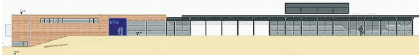
Das BTG-Gebäude vom Brodhagen aus: Links ist der Neubau mit neuem Eingang (blau) und Holzfassade zu sehen, rechts der Altbestand. Beide Gebäude werden verbunden. Allerdings werden sie zukünftig weitgehend von Pflanzen verdeckt sein.
